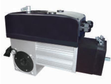
Průmyslové elektropohony Doorhan řady Shaft jsou určeny pro automatizaci průmyslových sekčních vrat. Shaft je boční pohon s převodovkou v «olejové lázni». Takováto konцепce umožnuje intenzivněji využívat pohon při jeho minimálním opotřebení. Pohon se skládá z elektrického motoru, mechanické převodovky a má zabudovanou řídící jednotku.
